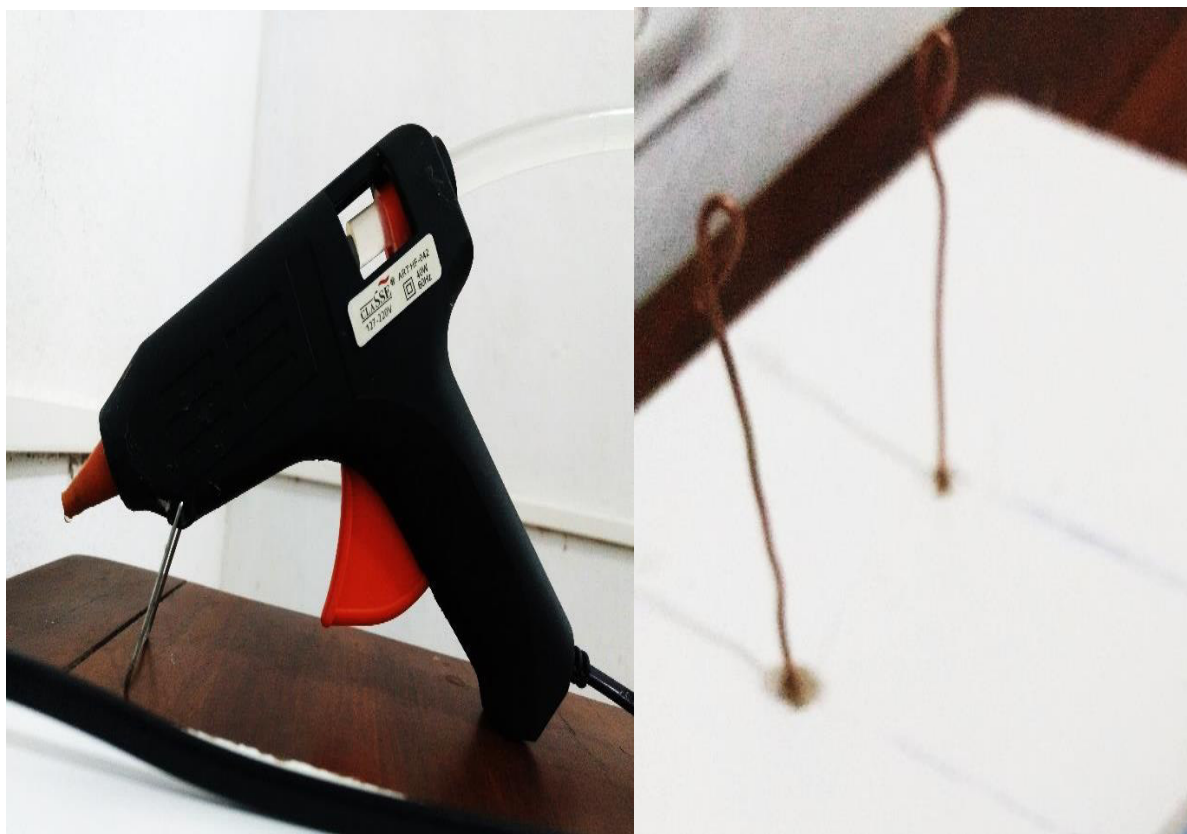
Figura 4.6: Pistola de cola quente e fios presos no suporte.
