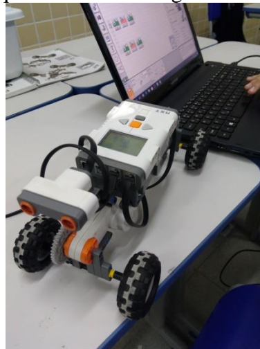
Figura 18 – Robô que executará frenagem e seu sensor ultrassônico
