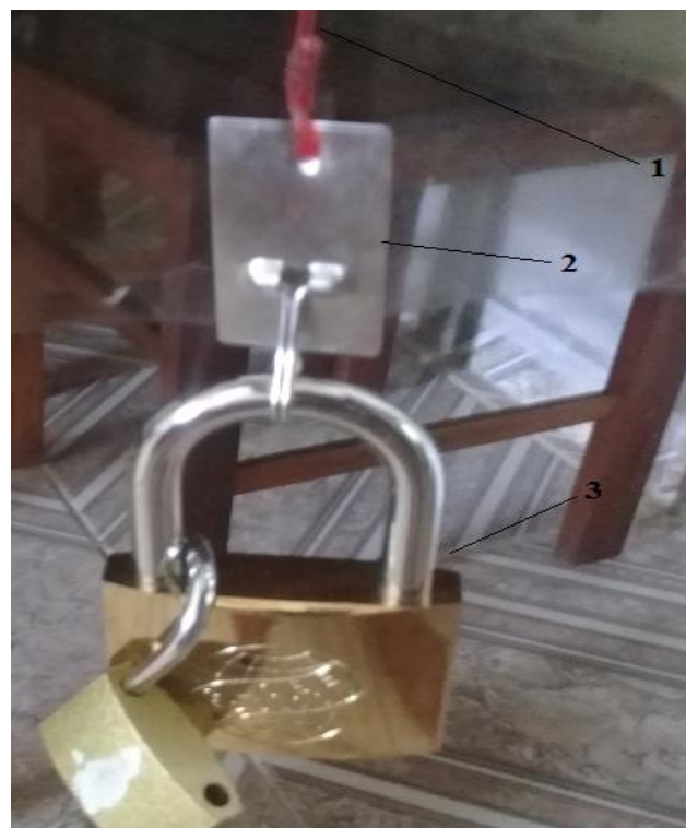
Figura 1.8: extremidade do fio presa a cadeados tracionadores
