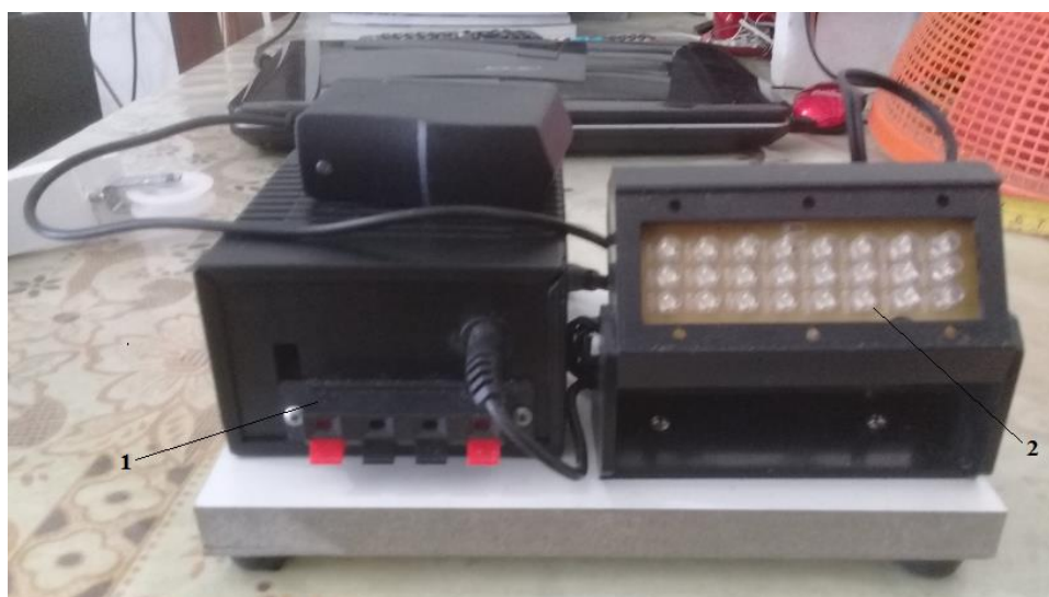
Figura 1.10: visão posterior da base de madeira com amplificador, estroboscópio e cabo de força
