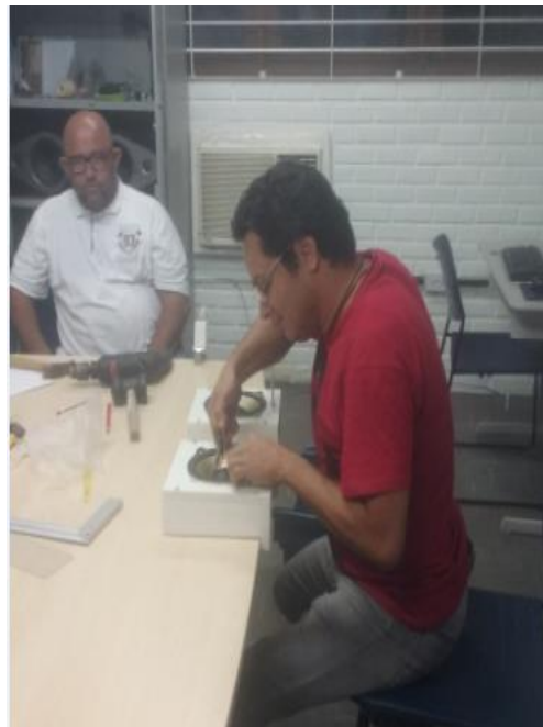
Figura 1.16: parafusagem do alto-falante na base de madeira Figura 1.17: colagem da haste de cobre
