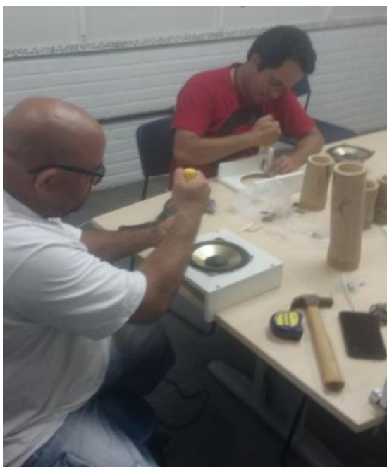
Figura 1.16: parafusagem do alto-falante na base de madeira Figura 1.17: colagem da haste de cobre
