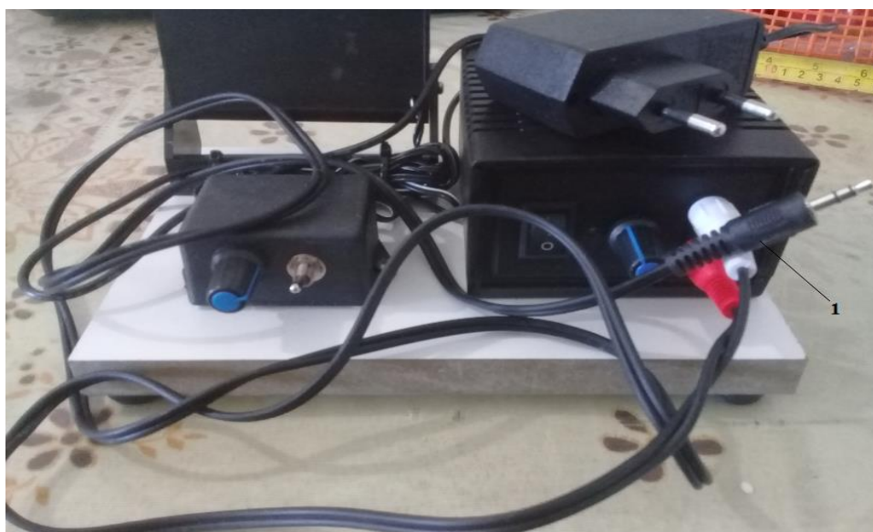
Figura 1.9: visão frontal da base com amplificador e cabo de áudio com as duas entradas RCA conectadas
