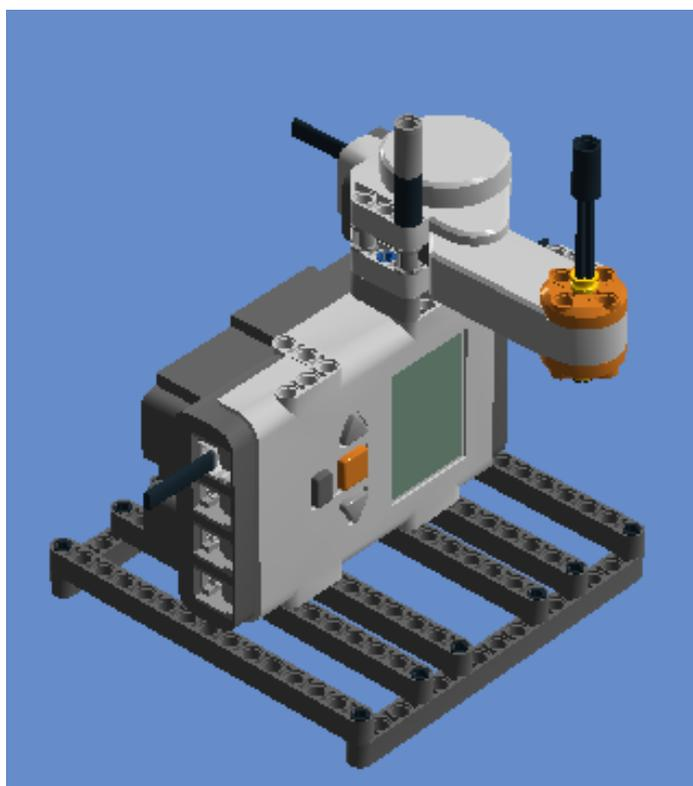
**10º Passo:** Angular beam 90degr. W.4 snaps, Tube Ø7,84 2m (4526982 e 4526985), Cross Axle 5,5 with stop 1m, Conn Bush W. Fric/Crossale e Lightsensor (conectar o cabo 1 ao sensor de luz)
