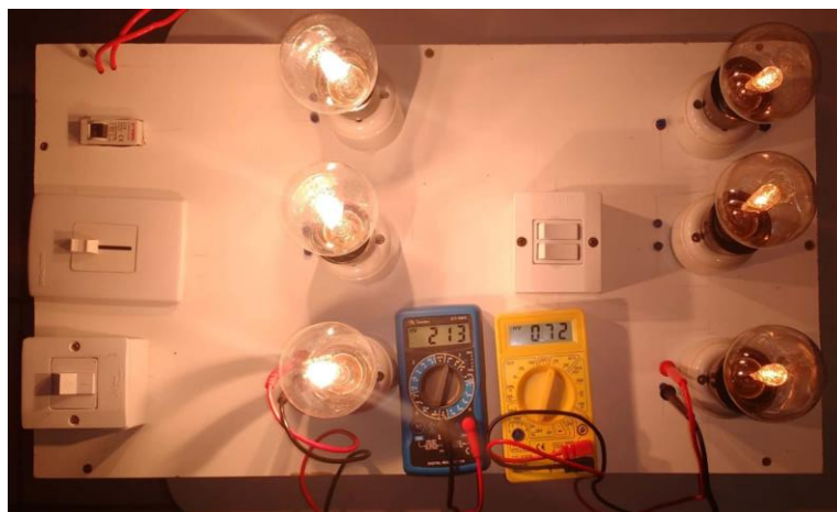
Figura 25 - Experimento nº5 com o brilho e as medidas da voltagem na associação em paralelo (esquerda) e em série (direita).
