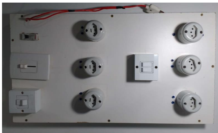
Figura 24- Experimento nº 5 feito para trabalhar associação de resistores em série e em paralelo
