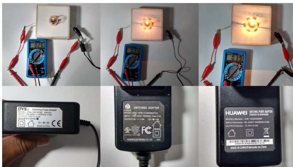
Figura 16 – Medida da corrente elétrica respectivamente: 5V, 9V e 12V
