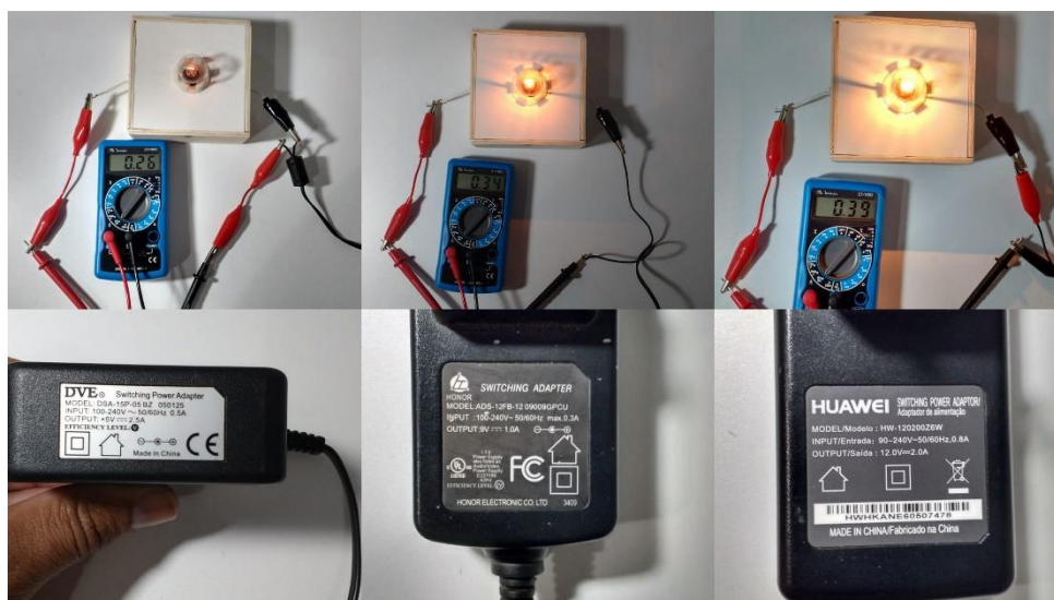
Figura 4 – Medida da corrente elétrica respectivamente: 5V, 9V e 12V
