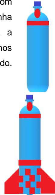
3º Passo: Na construção das aletas, vamos recortar da pasta plástica quatro aletas, conforme molde abaixo, fixar a saia e as aletas na saia. Lembre-se que a fixação tem que ser simétrica, assim cada aleta deverá está a 90º de distância. As dimensões indicadas na figura é uma sugestão, pois depende do tamanho do foguete
